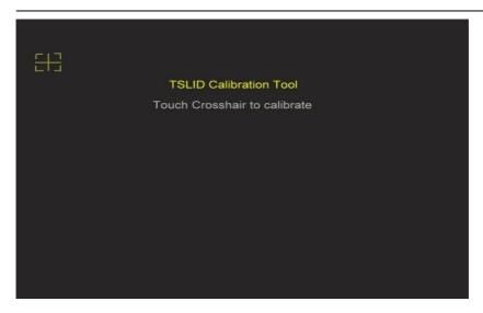
Bitte die 5 Kreuze KURZ antippen, um den Bildschirm zu kalibrieren. Zur Prüfung werden die 5 Punkte erneut abgefragt. Sollte hier ein Fehler passiert sein, wird die Kalibrierung neu gestartet.
