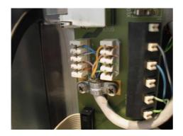
Nach dem Verdrahten werden das Datenkabel und das Flachbandkabel mit dem Gerät verbunden und das Gerät in den UP-Kasten eingesetzt.
