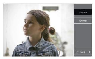
Die Sprechstelle KIV-1 hesitzt eine berühungsempfindliche Oberfläche. Beim Antippen der Anzeigefläche schaltet sich das Gerät ein und die Bedienelemente werden sichtbar. Betätigen einer Funktion ändert sich die Hintergrundfarbe der jeweiligen Tastenfläche zur Bestätigung.
