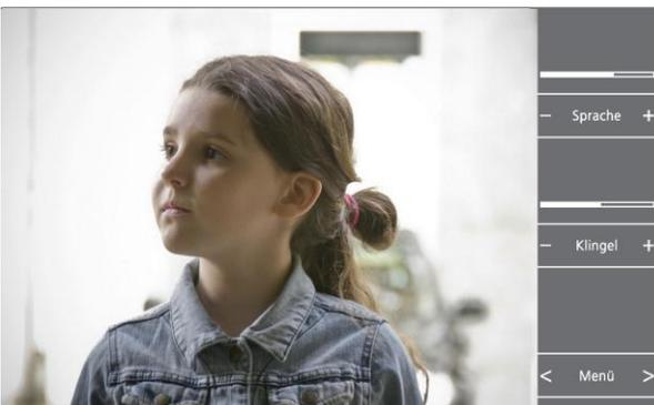
Einstellungen für Lautstärke oder Helligkeit werden durch Berühren der - oder + Symbole verändert. Wird die Klingellautstärke auf Null gesetzt, ist der Ruf stummgeschaltet! Die Stummschaltung wird mit einer roten Leuchtdiode in der Geräteöffnung signalisiert.
