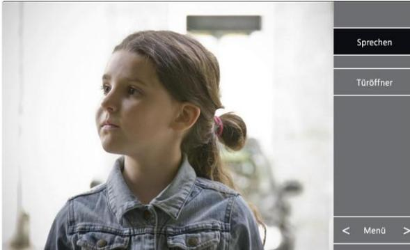
Die Sprechstelle KIV-1 besitzt eine berührungsempfindliche Oberfläche. Beim Antippen der Anzeigefläche schaltet sich das Gerät ein und die Bedienelemente werden sichtbar. Beim Betätigen einer Funktion ändert sich die Hintergrundfarbe der jeweiligen Tastenfläche zur Bestätigung.
