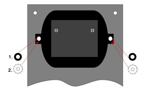
Nun setzen Sie die Kamera mit dem vorinstallierten Rahmen auf die Gewindebolzen auf, legen eine Unterlegscheibe Stärke 1mm darauf und fixieren die Baugruppe mit je einer Rändelmutter. Achten Sie bei der Montage darauf, dass die Kamera richtig herum eingebaut wird (Anschlussklemmen zeigen zur Mitte der Frontplatte)
