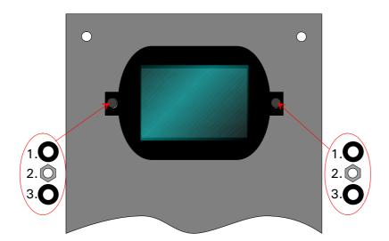
Zuerst setzen Sie je eine Unterlegscheibe der Stärke 1mm auf den Rahmen und fixieren diesen mit je einer Mutter.
