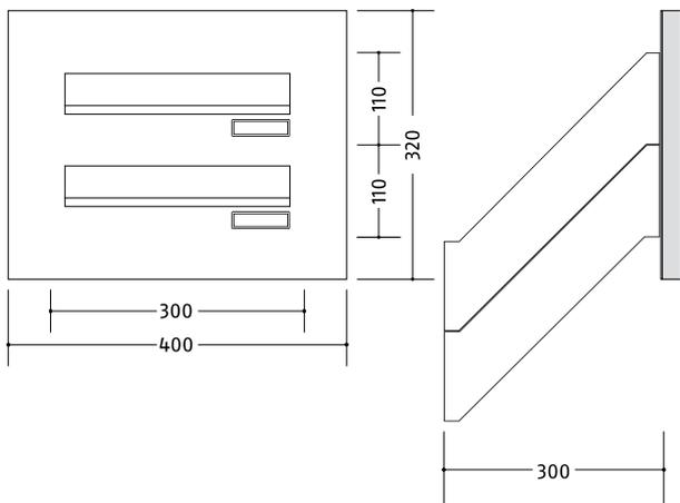
**Basic Edelstahl Standardanlagen für Türpaneel-Montage, ohne Technikfach**
