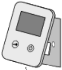
Abb. 5 Drücken Sie die Sprechstelle nun auf die Grundplatte, bis diese hörbar einrastet
