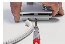
Abb. 3 Gleichzeitg Gehäusefront anheben und vom Unterteil entfernen.
