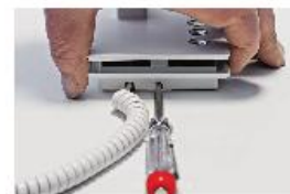
Abb. 3 Gleichzeitig Gehäusefront anheben und vom Unterblei entfernen.
