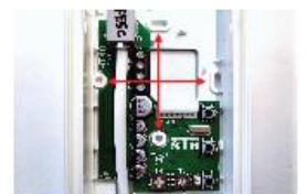
Abb. 4 Die Innensprechstelle kann nun wahlweise auf eine Schallentose oder plan an der Wand montiert werden (Befestigungsmaterial nicht im Lieferumfang).
