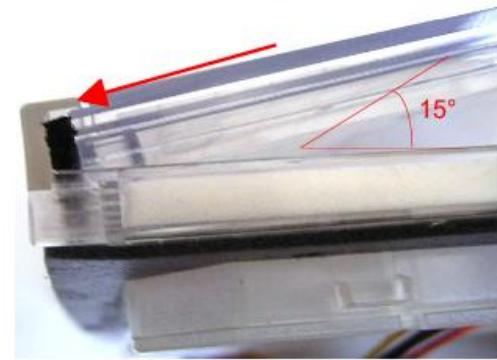
Taste im  $15^\circ$  Winkel unter Kante ansetzen und herunter drücken, bis diese einrastet.
