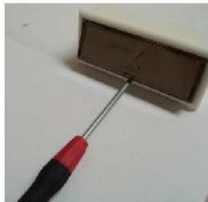
Benutzen Sie einen schmalen Schlitz-Schraubendreher, um die Rastnasen der Tastenwippe anzuheben.
