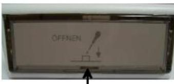
An der Unterseite der Tasten-Wippe befindet sich eine Einkerbung, hinter der sich die Rastnasen der Abdeckung befinden.
