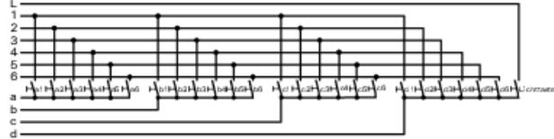
Es gibt vier Linien (a,b,c,d). Pro Linie können maximal 6 Klingelasten angeschlossen werden, also insgesamt 24 (mit Erweiterung E32 auch bis zu 184).
