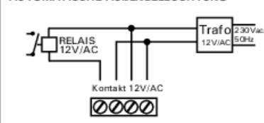
Spannungsversorgung: 12V ~ /1A
