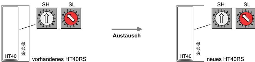
In diesem Beispiel sind die Rotationsschalter der vorhandenen Innensprechstelle auf SH=0 und SL=E eingestellt. Diese müssen Sie dann bei der neuen Innensprechstelle genauso einstellen.
