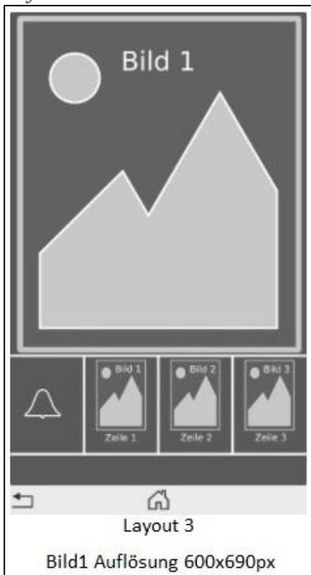
Das dritte Layout, stellt eine Mischung aus Layout eins und zwei dar. Es können zusätzliche Text-Informationen eingegeben werden und des Weiteren ist es möglich 3 Logos/Bilder einzufügen mit einer maximalen Größe von 600x690px.
