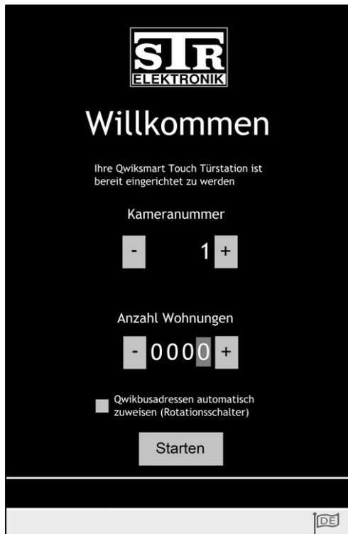
**Kameranummer:** Stellen Sie hier die gewünschte Kameranummer ein, in dem Sie auf die Plus- oder Minustaste tippen. Es können die Nummern 1-64 eingestellt werden. Standardmäßig ist immer die Kameranummer 1 vergeben. Zu einer Standard QwikBUS Anlage ist die Kameranummer mit den dort einstellbaren Türnummern vergleichbar. Wenn die QSTT Ihr Haupteingang ist, empfehlen wir hier die Kameranummer 1 einzustellen.
