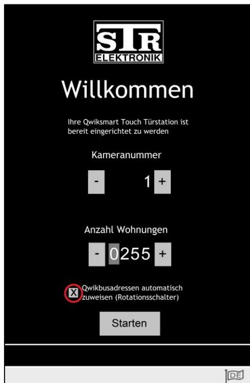
**Qwikbusadressen automatisch zuweisen:** Setzen Sie den Haken in der Checkbox (siehe rote Markierung), wenn denen von Ihnen angelegten Wohnungseinträgen automatisch eine Qwikbusadresse zugewiesen werden soll. Beachten Sie aber, dass dies nur funktioniert, wenn die verwendeten Endgeräte über die *Rotationsschalter zur Adresseinstellung* verfügen.
