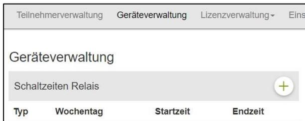
Unter Geräteverwaltung Schaltzeiten Relais, kann eine Zeitschaltfunktion für die Beiden Relais Türöffner (TOE) und das Licht-Relais (REL) angelegt werden.
