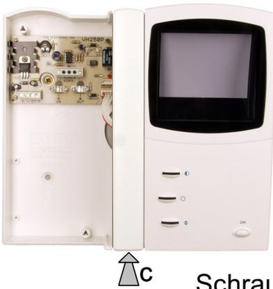
Schraube (c) herausdrehen und Mittelsteg entfernen
